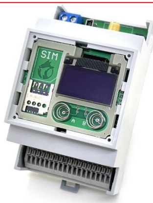
Рисунок 4.1 – Слот для установки SIM-карты под верхней крышкой
