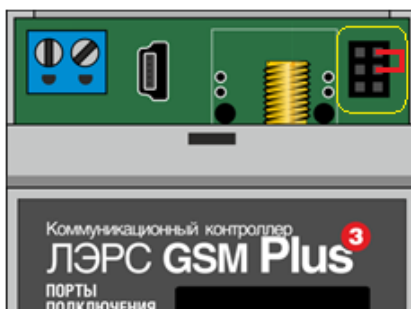
Рисунок 5.1 – Установка переключателя для обновления ПО
